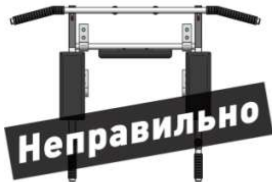
Рис. 2. Неправильная установка комплекса на стену
