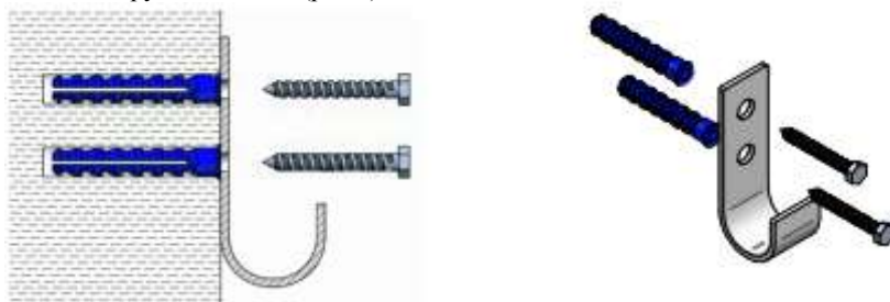
Рис.4. Крепление петель к стене
